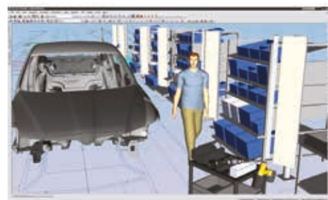
Analýza podsedavky Škoda Superb v Process Simulate Human
