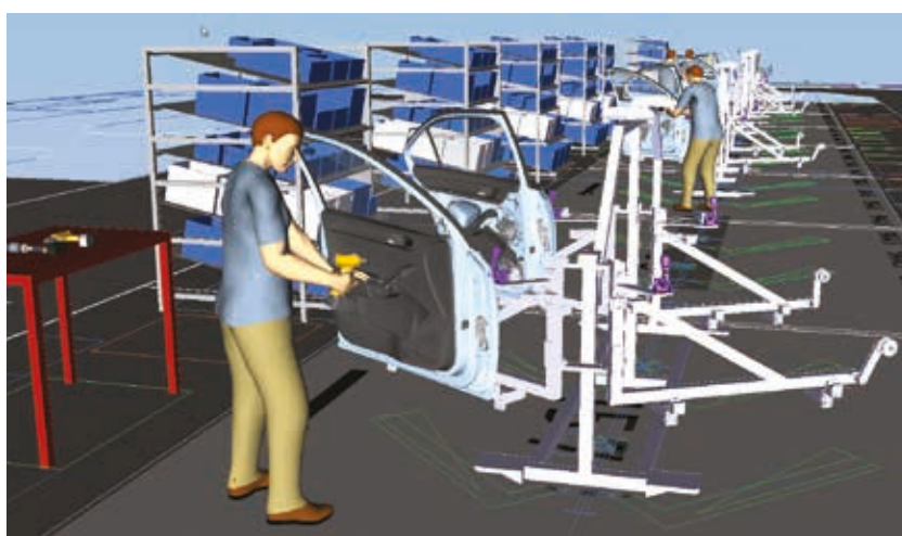
Analýza podsedavky Škoda Superb v Process Simulate Human
